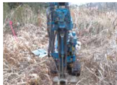
津波堆積物調査(ボーリング)
