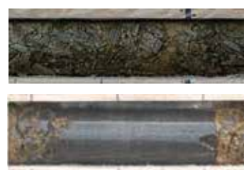
地すべり斜面の破碎岩（上）と、硬質礫・流ししやすい軟質粘性土からなるゆるみ岩盤（下）のコア採取例
