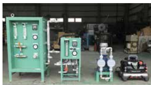
気泡発生装置（旧） 気泡発生装置（新） 送水ポンプ コンプレッサ IFCS工法の装置
