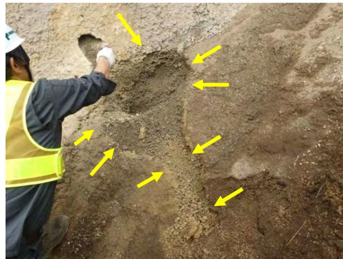
崩壊地側面のすべり境界部にへばりつく5mmほどの薄い幕地層の層序を切っているので、崩壊のセン断によって生じた熱~力学的変質、または被圧水による細粒分粒子の注入によって生じた膜と思われる。
