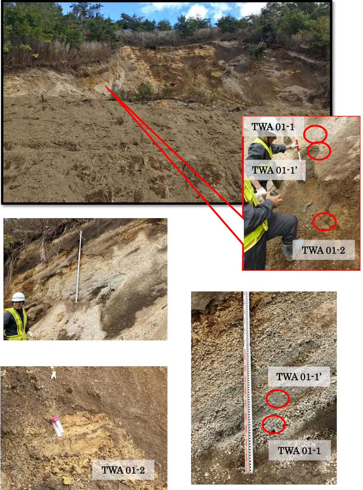
写真V-2-13 崩壊斜面の試料採取地点(厚真町東和)
