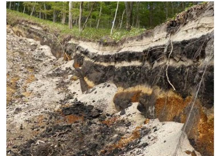
写真-6 崩壊 D の側面部 軽石と黒ボクの成層構造で、斜面傾斜は頭部で 20 度弱程度、下部では緩くなり 10 度程度
