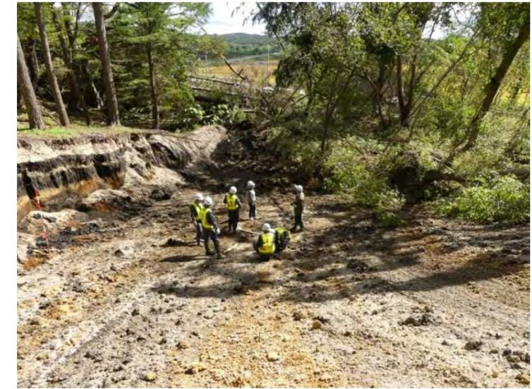
写真-4 南向斜面崩壊 D の頭部からの末端を見る。崩壊土砂が下部に堆積する。崩積土は泥濁化している。
