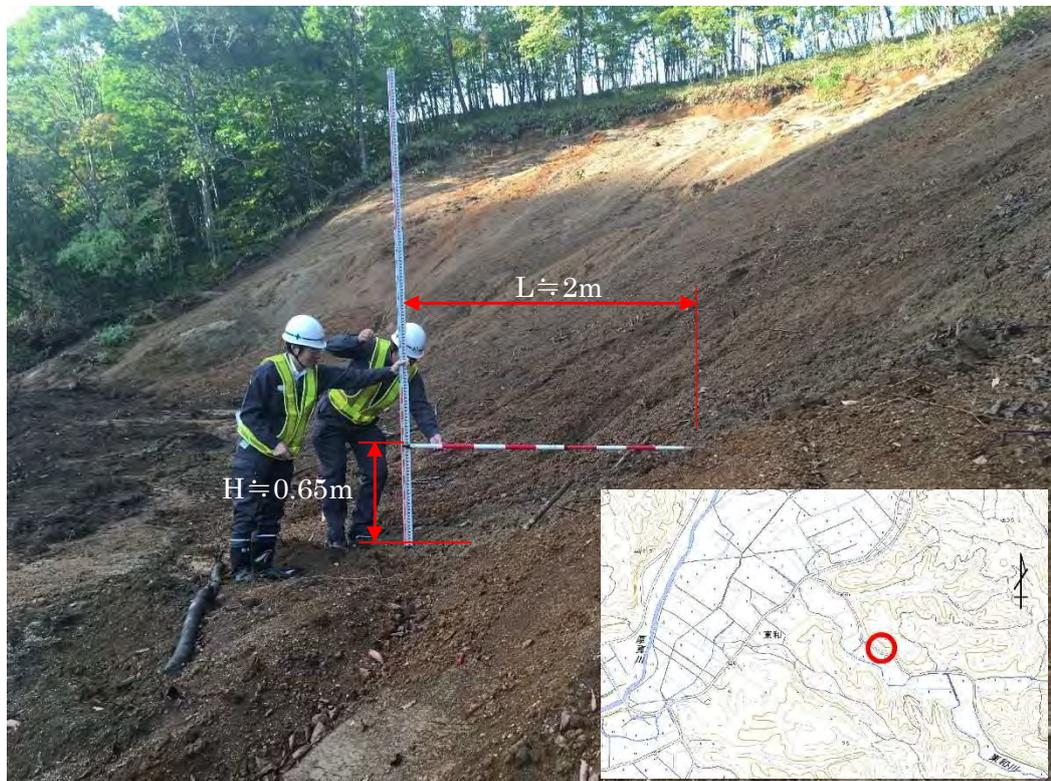
図 V-3-3 崩壊土の安息角測定状況
