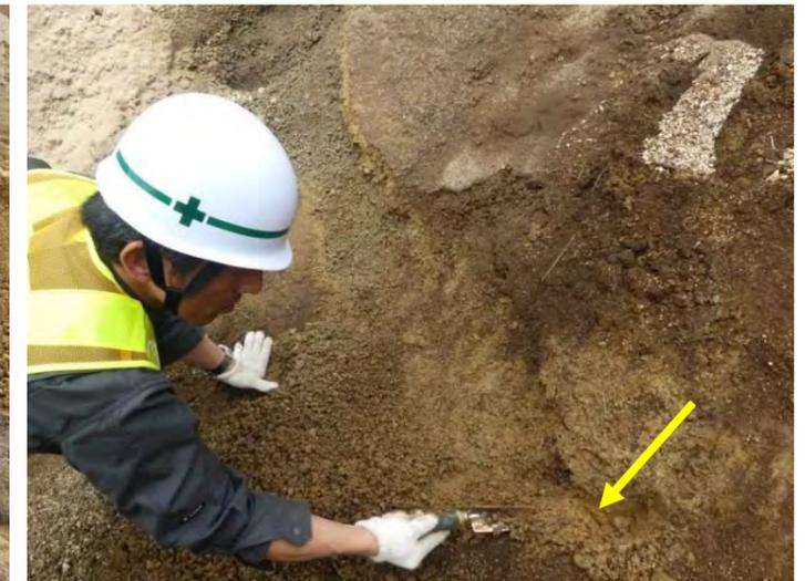
崩壊地底部に分布する粘性土層 矢印の先
