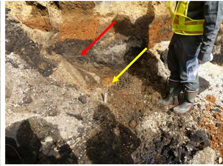
d 降下軽石(オレンジ色)の下位に分布する薄黄色の d 下部ローム層(黄色の矢印先)
