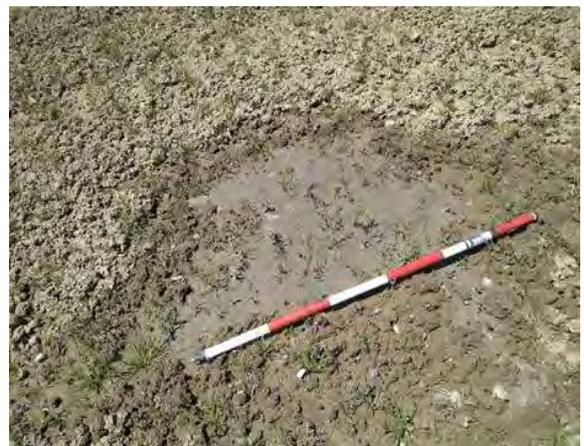
液状化噴砂跡。微細砂程度。
