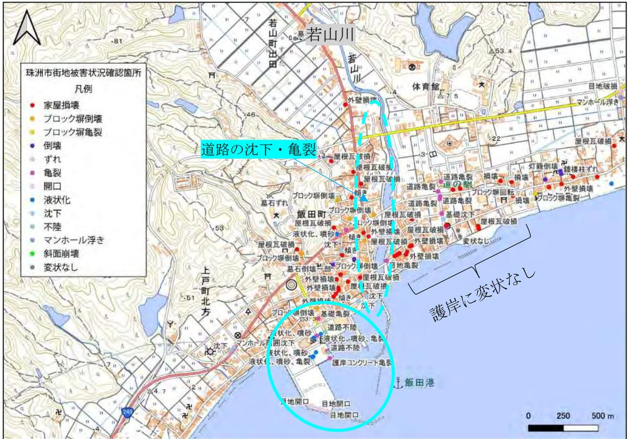
図Ⅲ-2-2 液状化や沈下等の確認箇所 エリア①：飯田港付近
