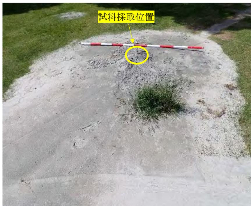
写真V-1-1 飯田港における液状化跡(試料採取地点)
