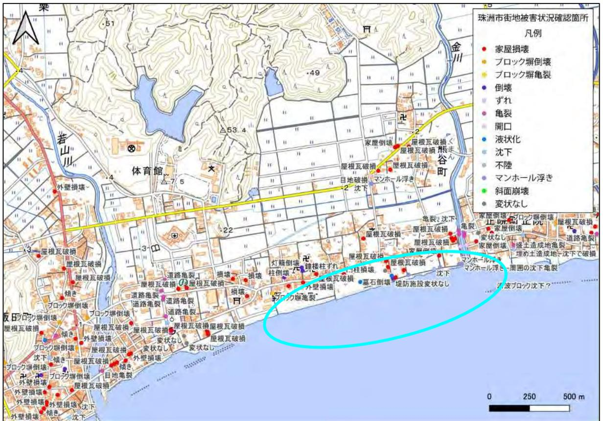
図Ⅲ-2-3 液状化や沈下等の確認箇所 エリア③：野々江町東部
