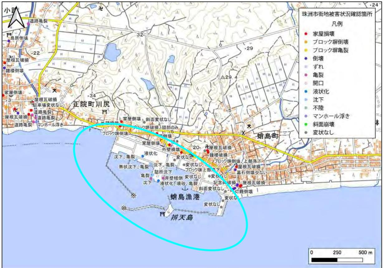
図Ⅲ-2-4 液状化や沈下等の確認箇所 エリア⑤：蛸島漁港付近
