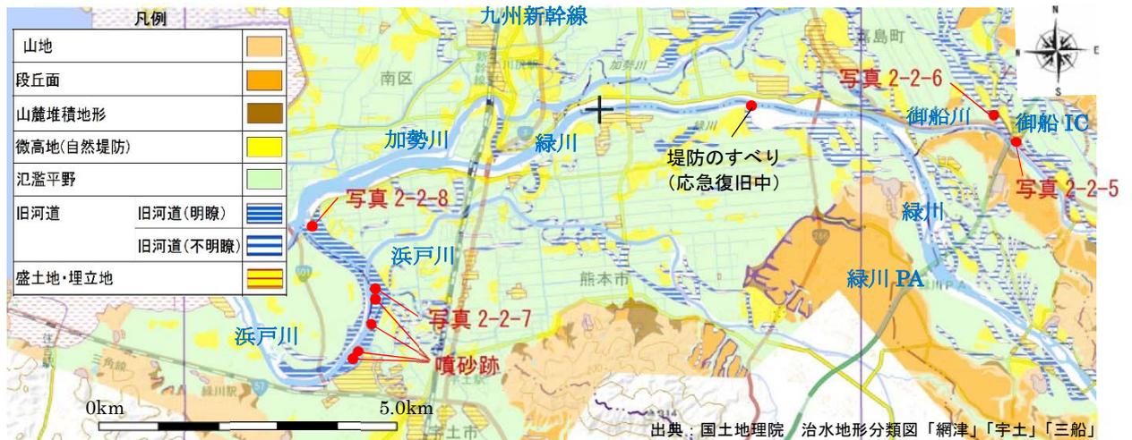
図 2-2-2 緑川流域の治水地形分類図と確認された液状化位置
