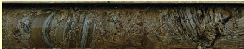
86mmのビニルスリーブ方式ダブルコアチューブを使用したダム貯水池地すべりの深度 20mにおける古生層千枚岩コア。
