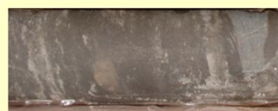
ビニルスリーブを使用し、深度 130mで採取した角礫凝灰岩を含む新第三系砂質泥岩コア。
