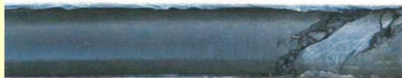
ビニルスリーブを使用したNQワイヤライン工法により、IFCS+無酸素ボーリング装置を用いて深度 315mで採取した珪質ノジュールを含む細粒凝灰岩及び硬質泥岩コア。
