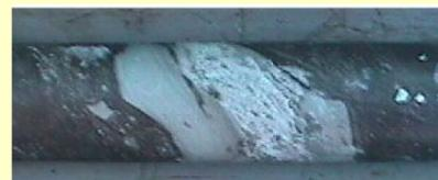
ビニルスリーブを使用したNQワイヤライン工法により深度 360mで採取した新第三系角礫凝灰岩層コア。
